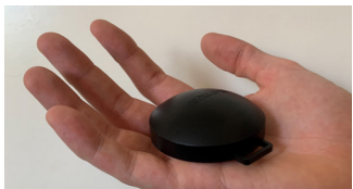
Das Radonexposimeter misst nur wenige Zentimeter und ist unkompliziert in der Handhabung. (Foto: NLWKN)
